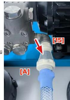
**3****Druckseite [5] anschließen:**
