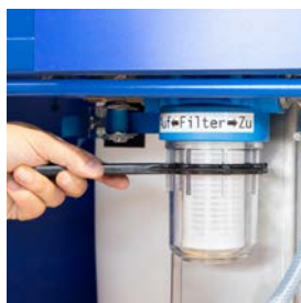
1.7 Den Filter mit dem beiliegenden Schlüssel öffnen und den Filtereinsatz entnehmen.
