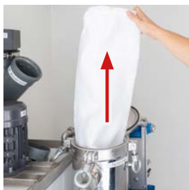
1.3 Filtereinsatz entnehmen. Edelstahlfilter zum Trocknen geöffnet lassen.
