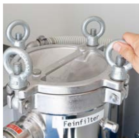
1.1 Flügelmutter des Feinfilters lösen.
