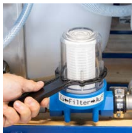
1.9 Den Filter mit dem beiliegenden Schlüssel öffnen und den Filtereinsatz entnehmen.
