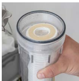
1.5 Ouvrir le filtre du préfiltre grand avec la clé fournie et retirer l'élément filtrant. Nettoyez le boîtier du filtre, laissez-le sécher et reserrer le couvercle.
