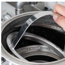
1.2 Tirer vers le haut la sécurité de l'élément filtrant à l'aide de la poignée métallique.
