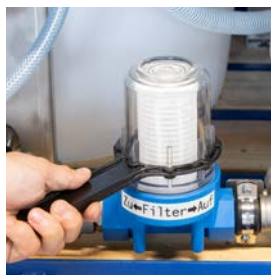
1.9 Ouvrir le filtre avec la clé fournie et retirer l'élément filtrant. Nettoyez le boîtier du filtre, laissez-le sécher et reserrer le couvercle.
