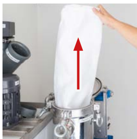
1.3 Retirer l'élément filtrant. Laisser la cartouche filtrante en acier inoxydable ouverte pour sécher.
