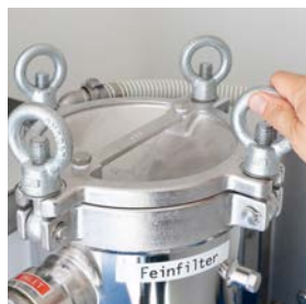
1.1 Desserrer l'écrou à ailettes du filtre fin.
