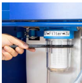
1.7 Ouvrir le filtre avec la clé fournie et retirer l'élément filtrant. Nettoyez le boîtier du filtre, laissez-le sécher et reserrer le couvercle.
