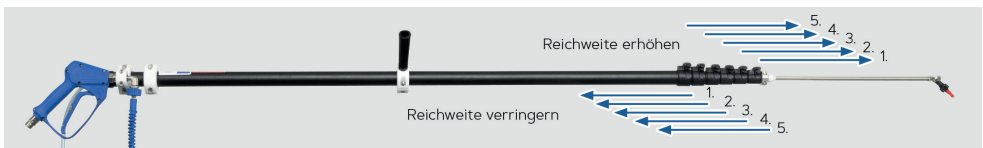
Abb. 29: Reihenfolge der Lanzenstangen für die Erweiterung und Verringerung der Reichweite.
