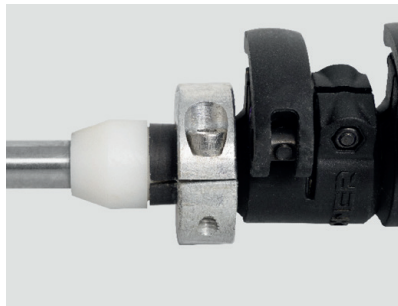
Abb. 19: Die Position des Spalts zwischen den Klemmringhälften stimmt mit der Position der Einschlitzungen auf dem Lanzenrohr überein.
