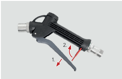
Abb. 6: Entsichern: Den Abzugshebel vom Sicherungsstift wegziehen. Den Sicherungsstift einklappen.
