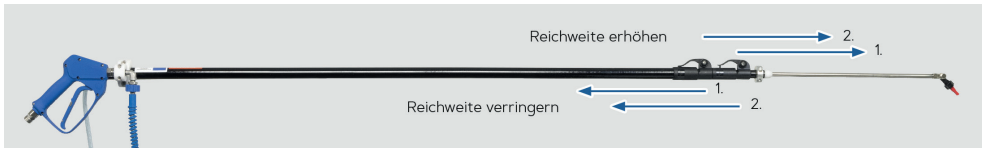
Abb. 23: Reihenfolge der Lanzenstangen für die Erweiterung und Verringerung der Reichweite.
