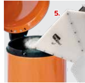
2.4 Überschüssiges Spaltmittel ggf. vorsichtig mit Hilfswerkzeug wie Schraubenzieher o.ä. komplett entfernen und fachgerecht entsorgen.
