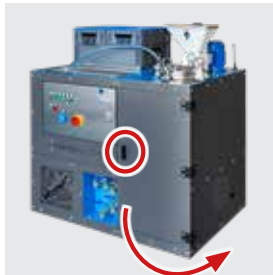
1.5 Den Filter von Vorfilter groß mit dem beiliegenden Schlüssel öffnen und den Filtereinsatz entnehmen.
