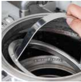
1.2 Die Sicherung des Filtereinsatzes mit Handgriff aus Metall nach oben herausziehen.
